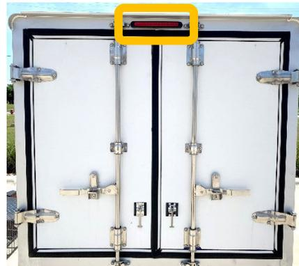
*Figure 13 Feu de freinage surélevé et central (FFSC) au-dessus de la charge utile et sur le fourgon*
