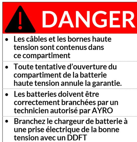
Figure 5 Étiquette de sécurité pour le compartiment de la batterie haute tension
