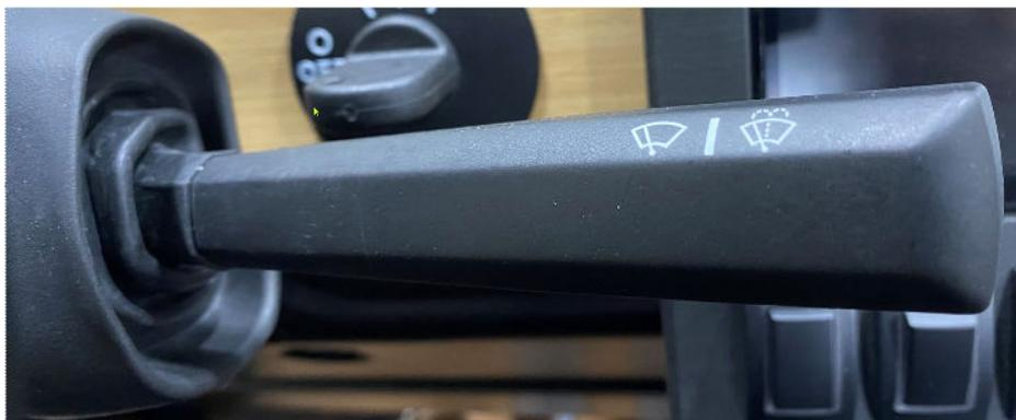
**Figure 15 Manette de commande des pare-brises et essuie-glaces**
